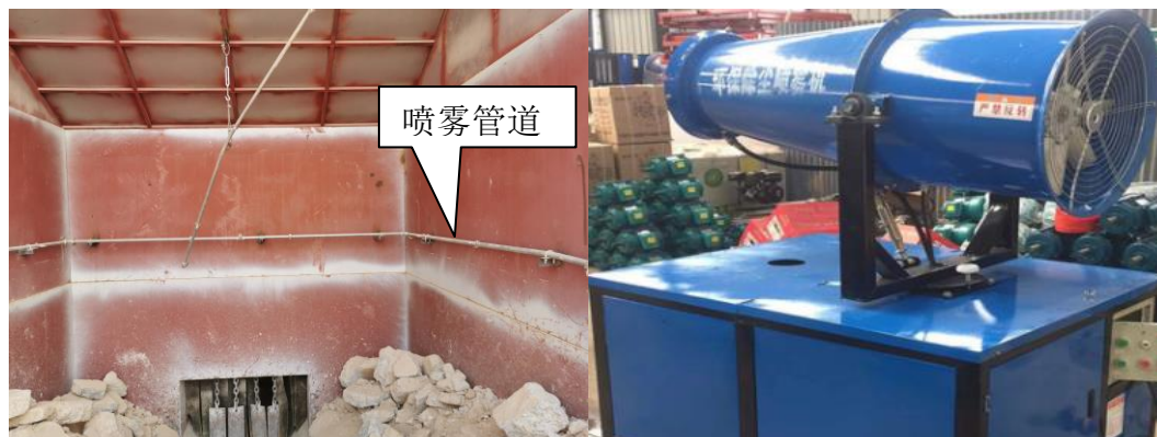
干雾抑尘装置（实物图片）雾炮（参考图片）
