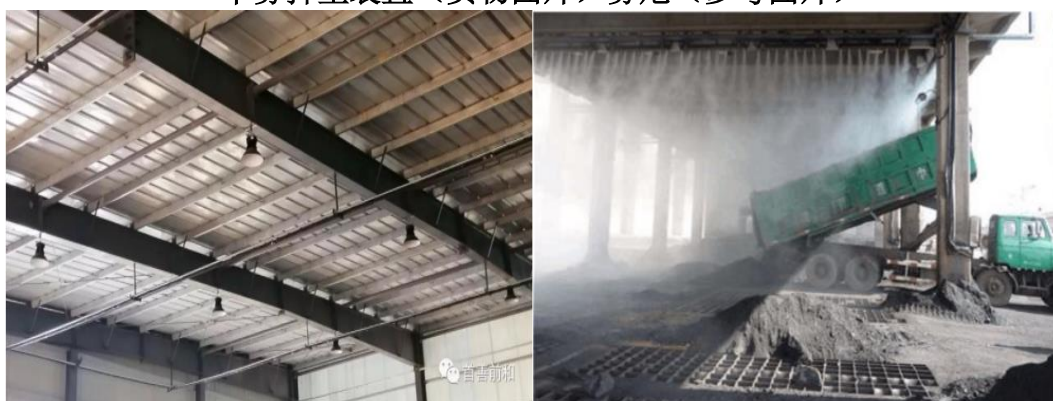
堆场干雾抑尘装置（参考图片）堆场干雾抑尘装置（参考图片）
