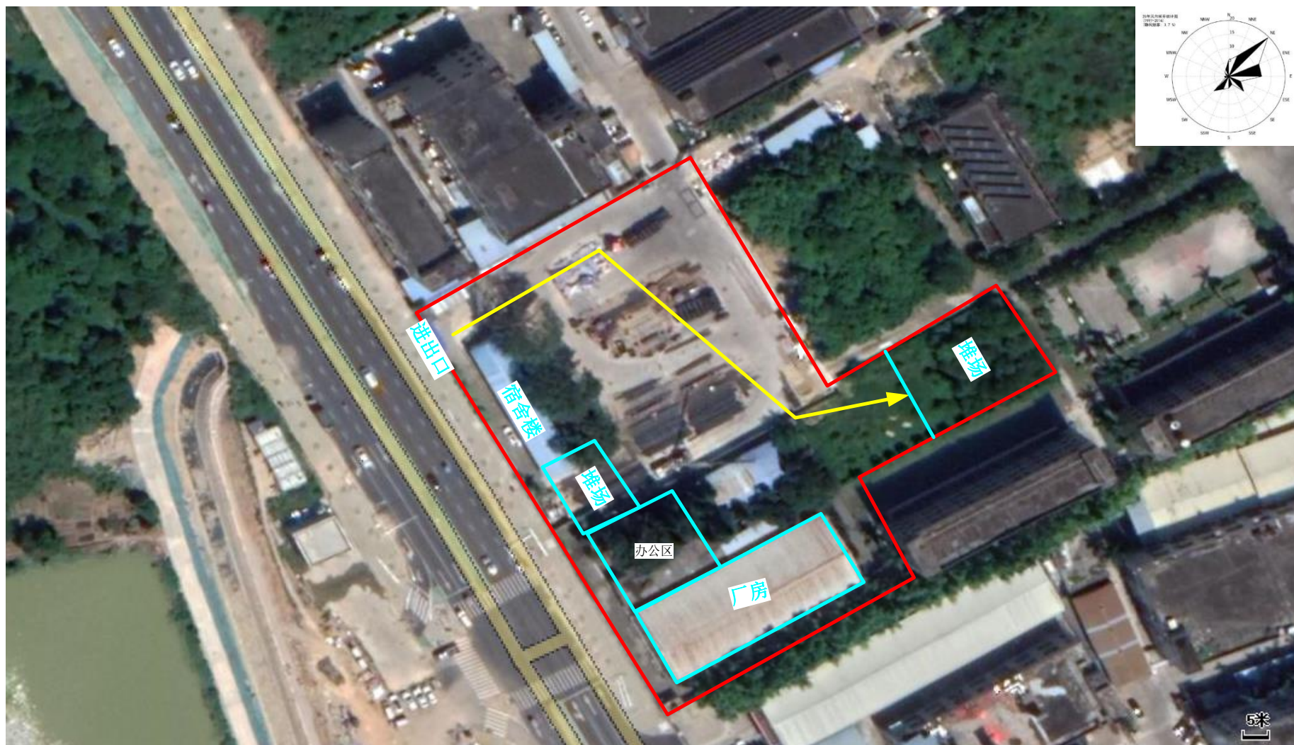
附图 10 项目总布置图及场区内车辆行进线路图
