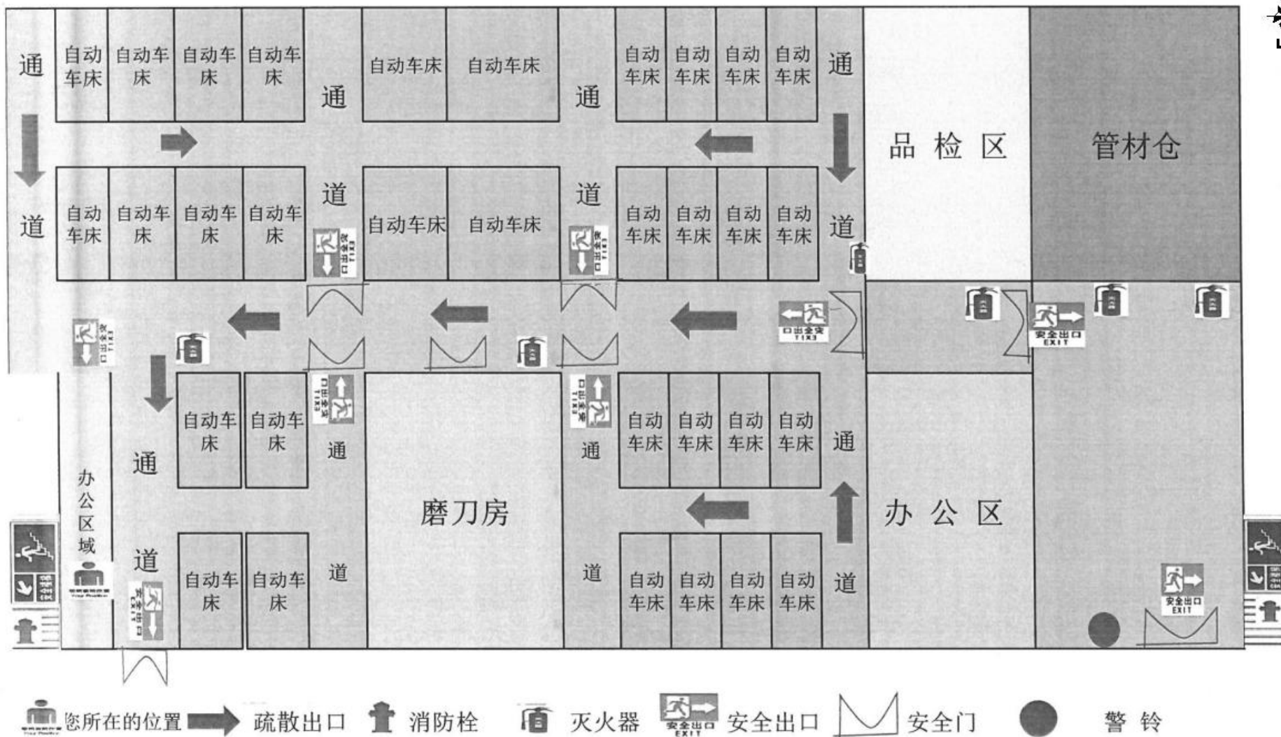
附图 11-3 项目 18 号厂房平面布置图
