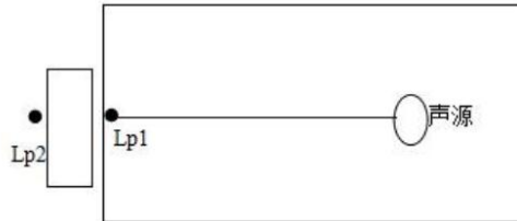
图 4-3 室内声源等效为室外声源图例
