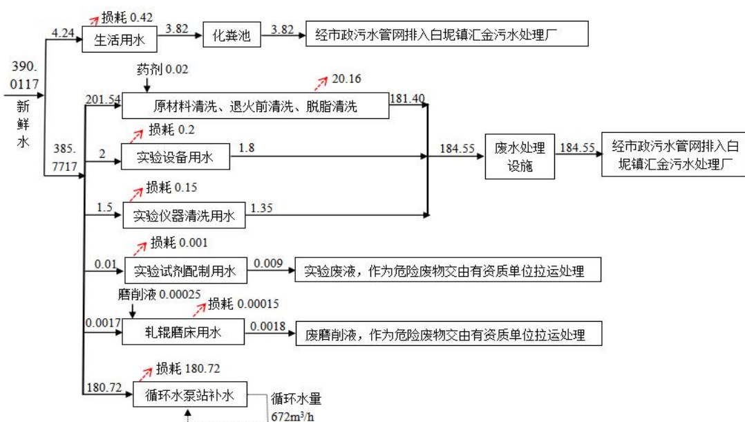
图 2-1 项目水平衡分析图（单位 m³/d）
